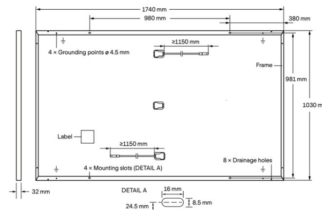
**Abb. 1:** Außenmaße (in mm) und Komponenten für Q.PEAK DUO-G6, Q.PEAK DUO-G6+, Q.PEAK DUO BLK-G6 and Q.PEAK DUO BLK-G6+
