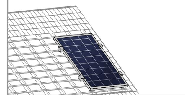
→ Halten Sie einen Abstand zwischen den Modulen von mindestens 10 mm entlang der kurzen Seite und 5 mm entlang der langen Seite ein.
